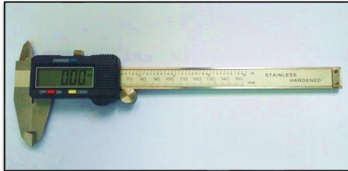
**FIGURE 1: MITUTOYO DIGITAL VERNIER**
